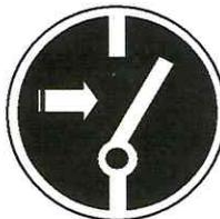
Vor Wartungs- und Reparaturarbeiten den Hauptschalter für die Stromversorgung ausschalten und mit einem Vorhängeschloss sichern! Der Schlüssel zu diesem Schloss muss in Händen der Person sein, welche die Wartungs- oder Reparaturarbeit ausführt!
